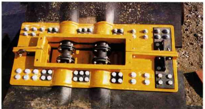
▼FRP製アンカー取付けプレート
